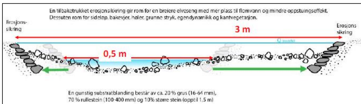
Figur 2-3 Prinsippskisse for utforming og erosjonssikring av nytt bekkeløp med dimensjoner basert på Gyllbekken. (Kilde: Uni Research)
